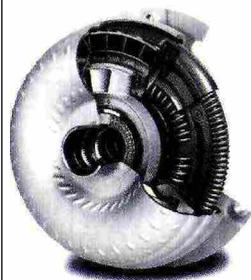
ZF Aftermarket introduce 20 nuovi convertitori di coppia a marchio Sachs di qualità OE. Il convertitore di coppia è un componente fondamentale per il funzionamento di una trasmissione automatica. Il suo compito è gestire l'accoppiamento convenzionale separando il motore e la trasmissione e poi ricollegandoli. In questo processo, la girante pompa trasferisce l'energia cinetica del motore alla trasmissione per mezzo di un flusso di lubrificante direzionato dallo statore alla ruota della turbina.
